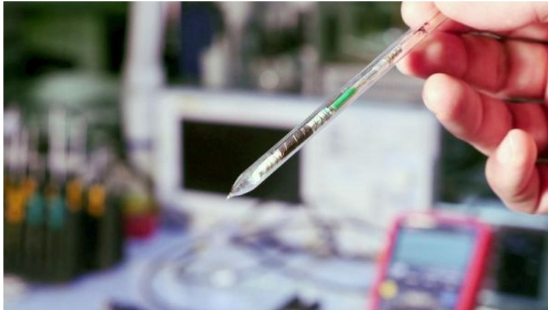
Testzelle für Lithiumionen-Batterien (Forschungszentrum Jülich / T. Schlößer)
