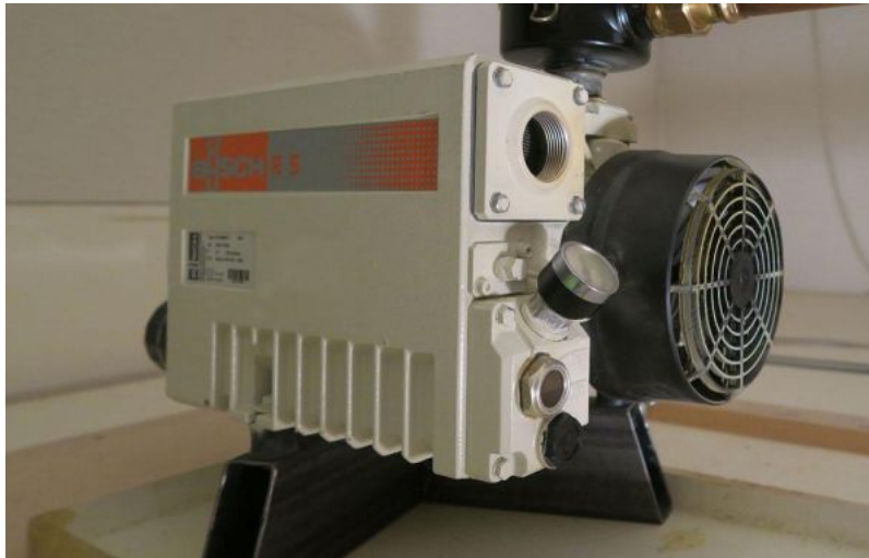
R 5 Drehschieber-Vakuumpumpe zur Evakuierung der Form und zur Infusion des Harzes
