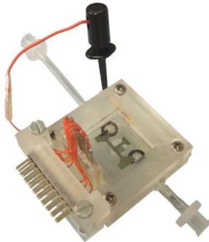
Halterung mit EWOD-Chip und Anschlüssen für die Ansteuerung. (© Fraunhofer FIT)
