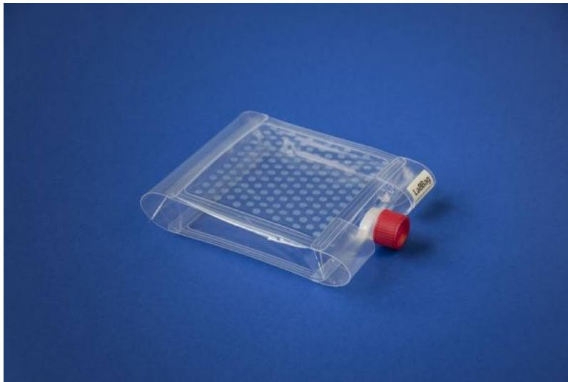
Das Mini-Labor ist 150 mm lang, 120 mm breit und 20 mm hoch. (© Fraunhofer IST)
