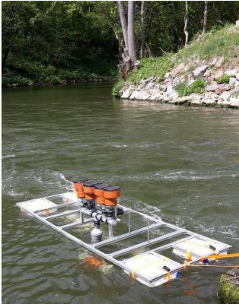
Feldversuch mit DEGREEN-Generatoren in einem Fließgewässer. Die Anregung der Silikonmembranen erfolgt über den Unterdruck in den wasserdurchströmten Venturi-Rohren unter dem Floß. (© Fraunhofer ISC)
