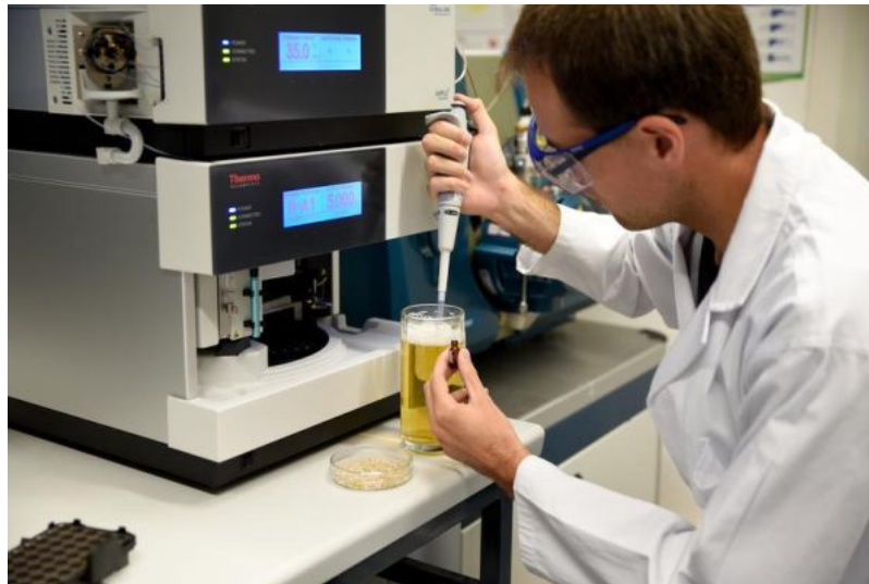
FAU-Forscher Thomas Sommer entnimmt eine Bierprobe. Nach der Aufbereitung wird der Hordeningehalt der Probe mittels Hochdruckflüssigkeitschromatographie mit gekoppelter Massenspektrometrie untersucht.
