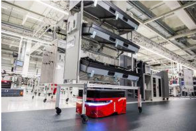
Der kleine Logistik-Roboter Karis Pro kann erstaunlich große Lasten Transportieren. (Bild: KIT, Audi Sport GmbH)
