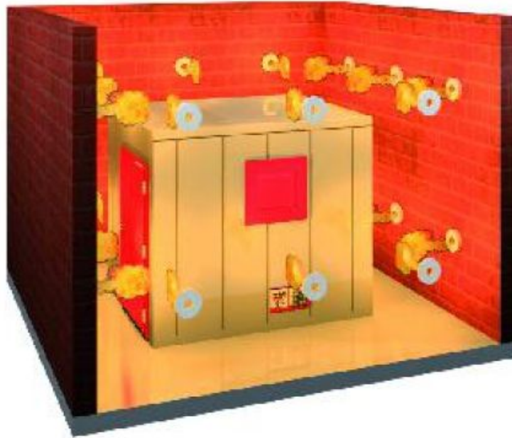
Befeurungssystem nach EN 1047-2. (Foto Nr. 238 - RZ-Products GmbH)
