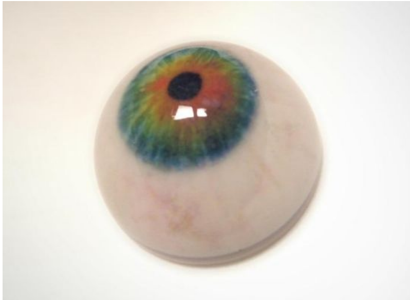
Augapfel farbkalibriert im 3D-Druck mit transluzenter Oberfläche
