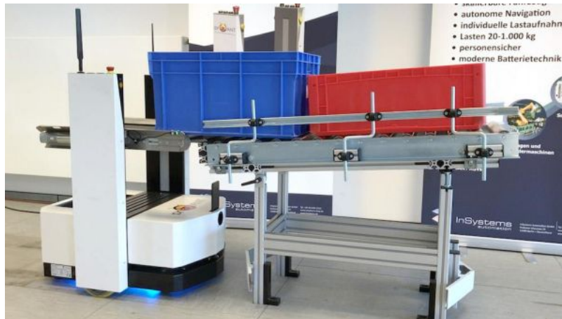
proANT Transportroboter für KLT Behälter an einer exemplarischen Übergabestation
