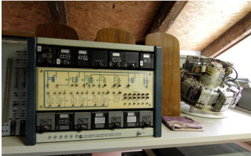
Ein Exponat im Magazin des HTWK-Automatikmuseums: Mit diesem Gerät aus DDR-Zeiten haben Wissenschaftler seinerzeit rein pneumatisch Regelstrecken und Regelkreise simuliert. (Foto: D. Lange/HTWK Leipz)
