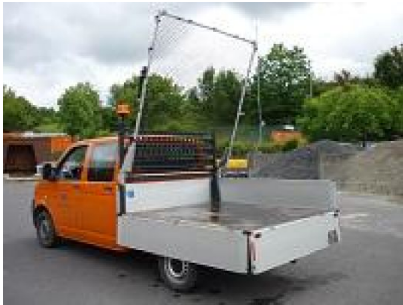
Bauhof mit Ladungssicherungssystem AR 3010
