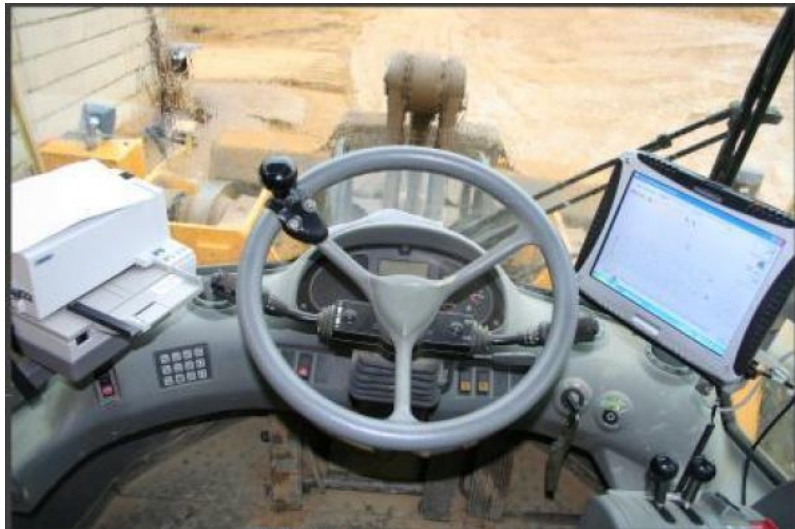
Innenansicht eines Radladers mit dem Bedienterminal und Drucker
