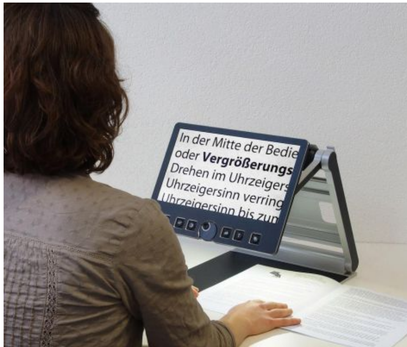
Das VisioBook: Dank schwenkbarer Kamera auch bei Vorträgen Text und Bild bis zu 30-fach vergrößern.
