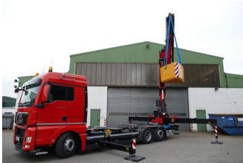
Baustoff-LKW, Ladekran für Container und Baustoffe
