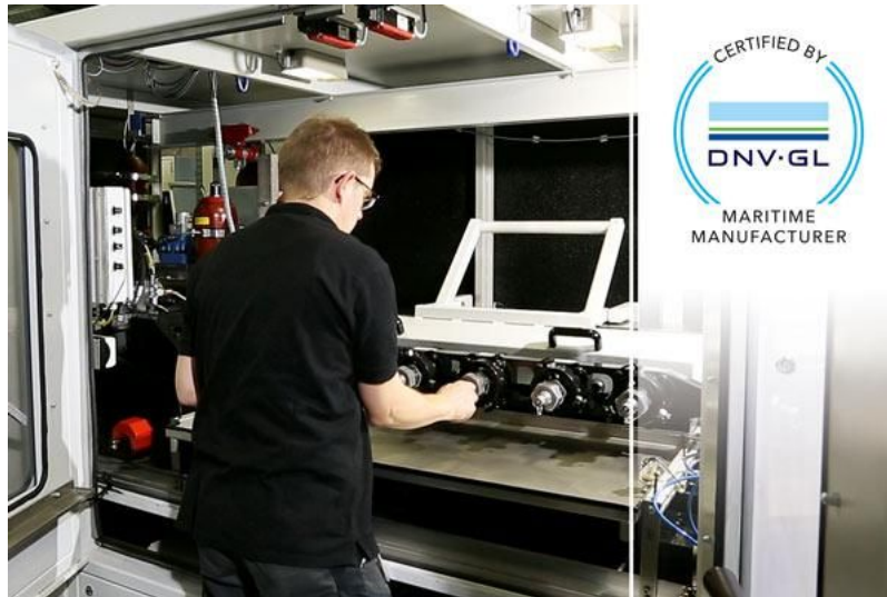
Hauseigener Biegewechseldruckimpulsprüfstand im Werdohler Technologiezentrum von Stauff
