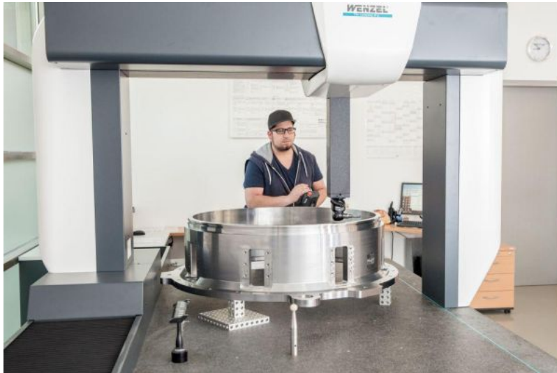
Messtechniker Nico Zebrowski mit „seiner“ Wenzel LH 108 beim Messen des Außenrings (Quelle: Lometec)
