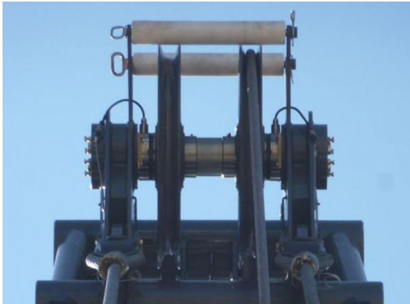
Zwei Kraftmesshülsen auf einer Achse
