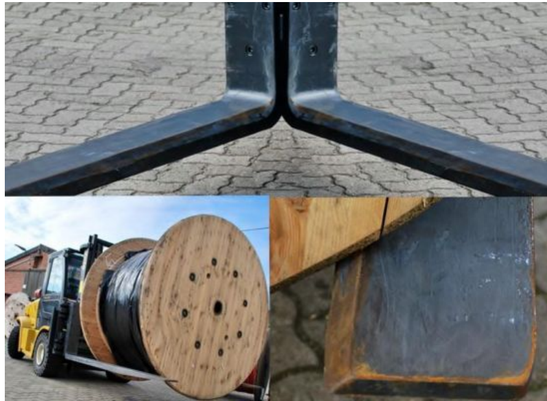
Gabeln mit Fasen an der Innenseite zum Transport von Kabeltrommeln oder anderen runden Gütern
