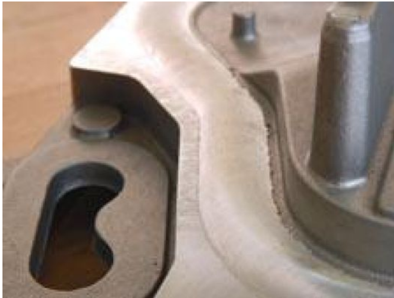
Rührreibgeschweißte Naht an einem Aluminiumgussteil.
