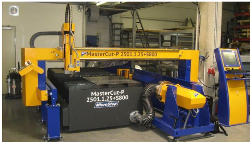
Die MicroStep-Anlage der MasterCut-Baureihe hat einen Arbeitsbereich von 2.500 mal 1.250 mm.
