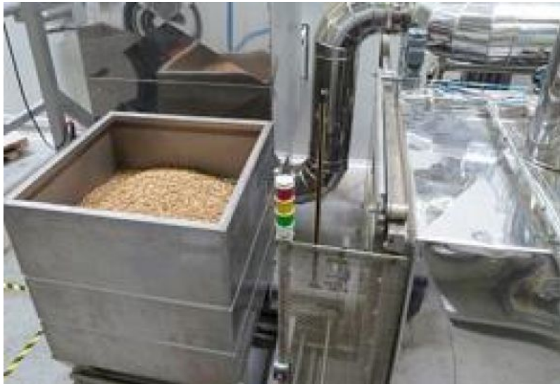
Steripure bietet die Entbakterisierung von Produkte durch Zugabe von Sattdampf in ein Vakuum
