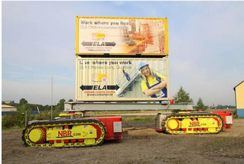
a geht was: Das Transportsystem NBR Crawler transportiert neben ELA Containern Lasten bis zu mehrere
