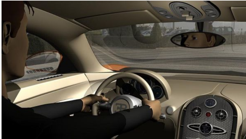
Sichtbarkeitsuntersuchungen im virtuellen Fahrzeug [Bild: ESI-IC.IDO]
