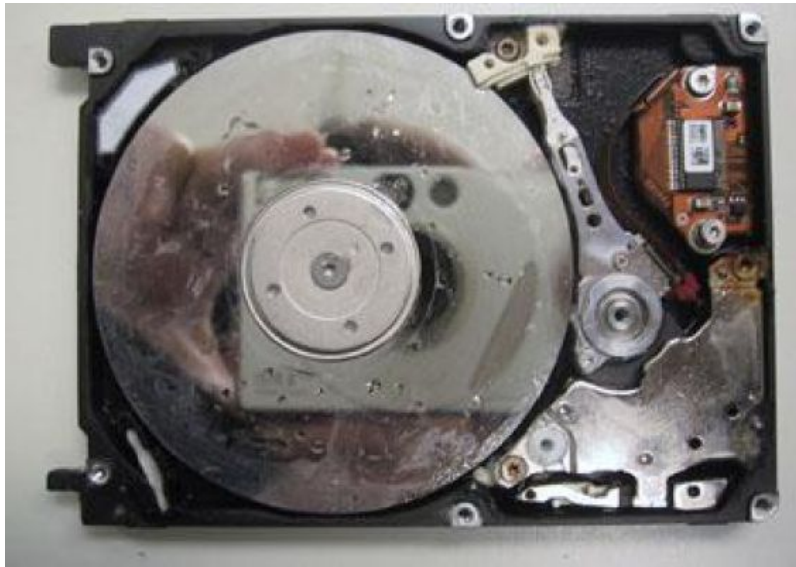
Datenrettung steht bei Wasserschaden unter Zeitdruck - Korrosion verschlimmert den Schaden
