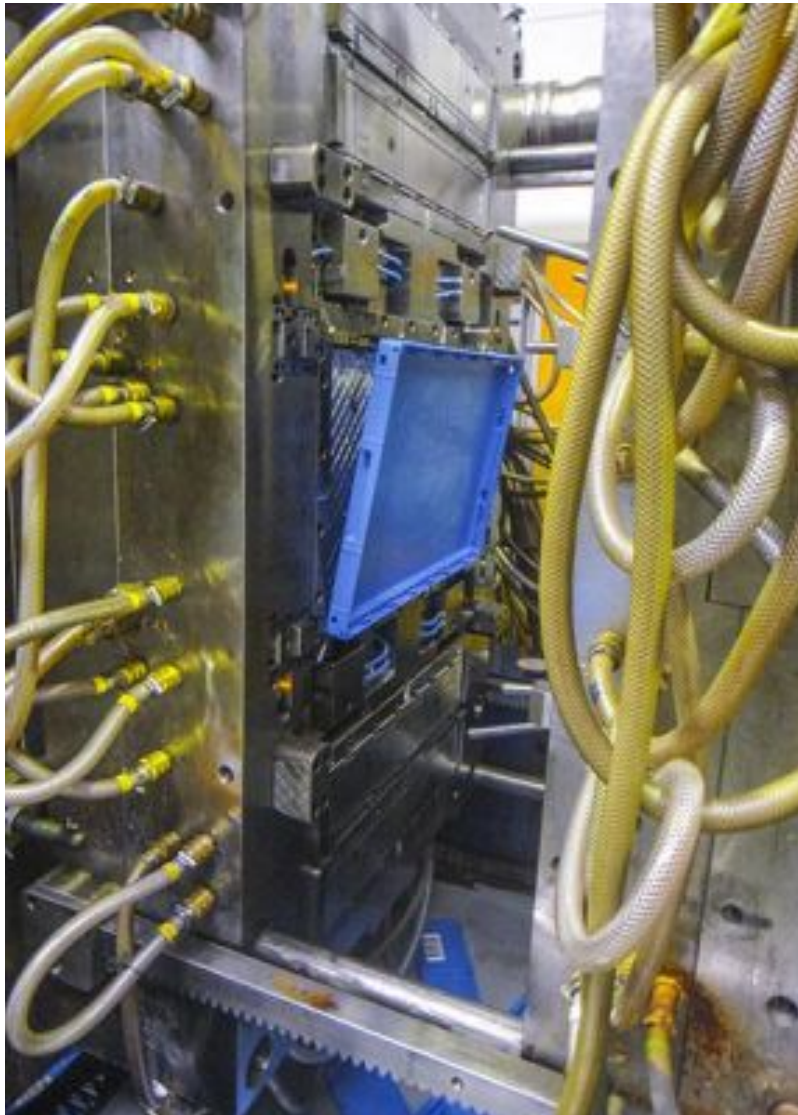
Ein neuer Faltbox-Boden löst sich aus dem Werkzeug. Die Seitenwände sind bereits entfernt.
