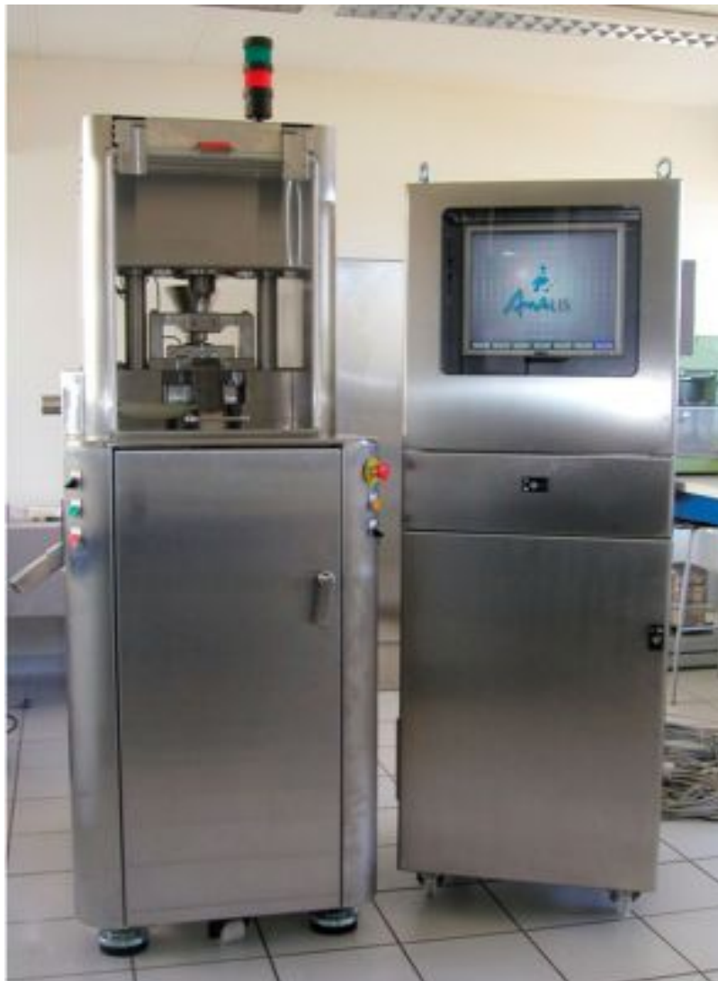
Die Forschungspresse STYLCAM 200R von Medelpharm analysiert die Pressfähigkeit von Pulvern
