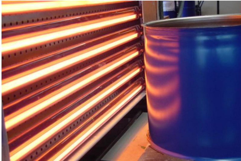
Infrarot-Wärme hilft Schutzlacke auf Blechdosennähten effizient zu trocknen.
