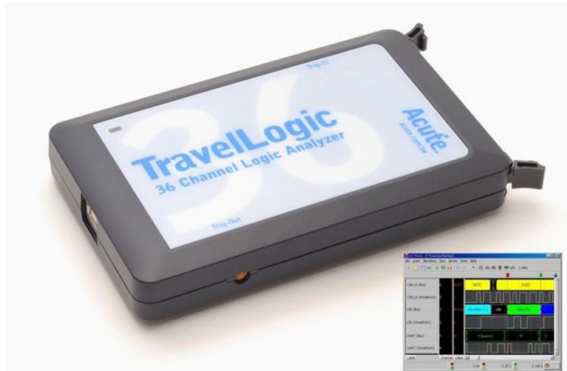
PC-Logikanalysator mit 4GHz Timing Analyse
