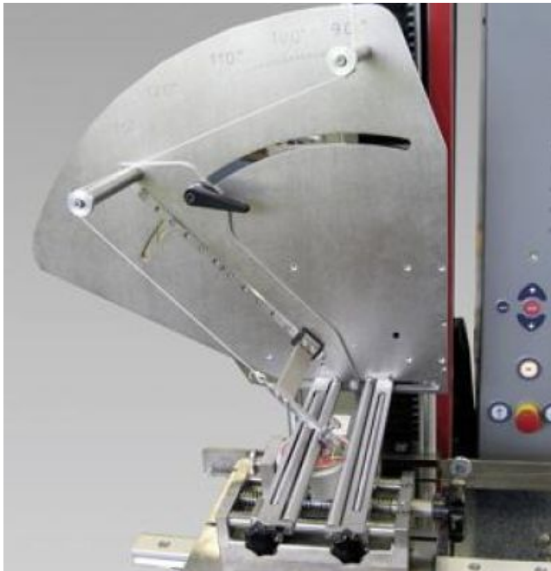
Abzugswinkel der von Zwick entwickelten Deckelabzugsvorrichtung, Einstellung zwischen 90 und 155°
