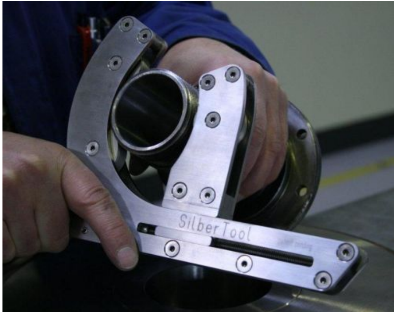
Rudge-Gewinde reparieren mit dem silbertool R110
