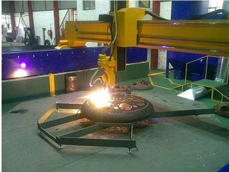
Die SMG Anlage von MicroStep in Aktion bei der Bearbeitung von Klöpperböden
