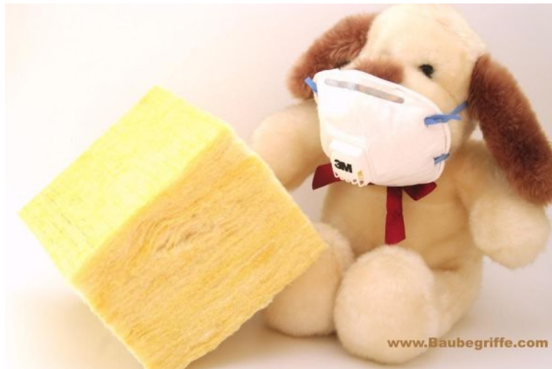
Glaswolle nicht ohne Schutzausrüstung
