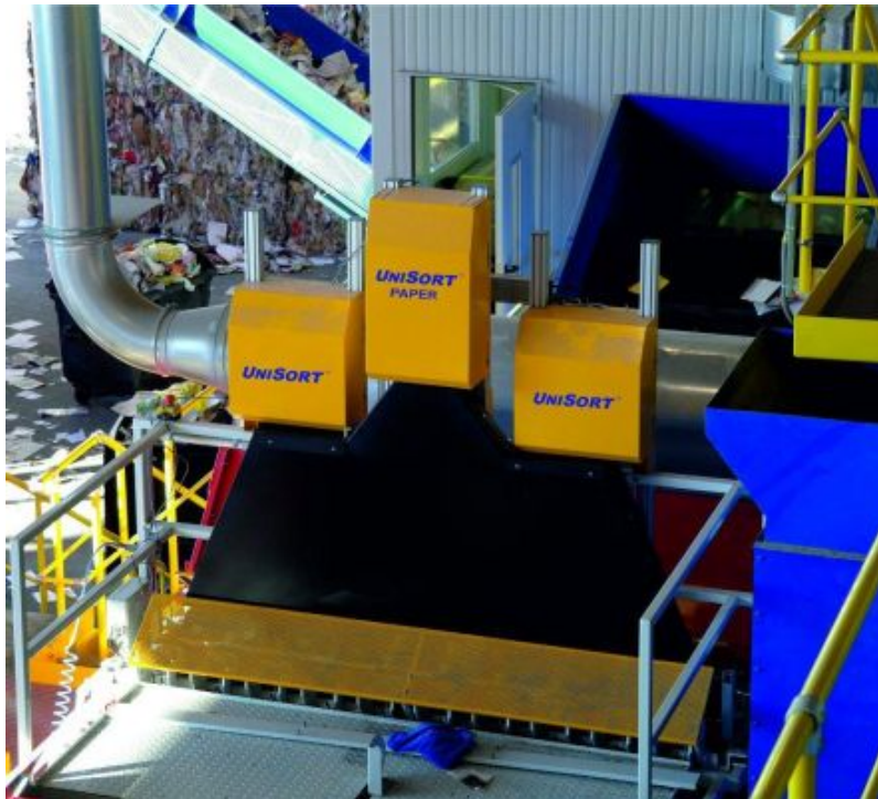
Der UniSort PC Paper sortiert Altpapier mit Nah-Infrarot- und Farb-Sensorik nach Papierart und -farbe
