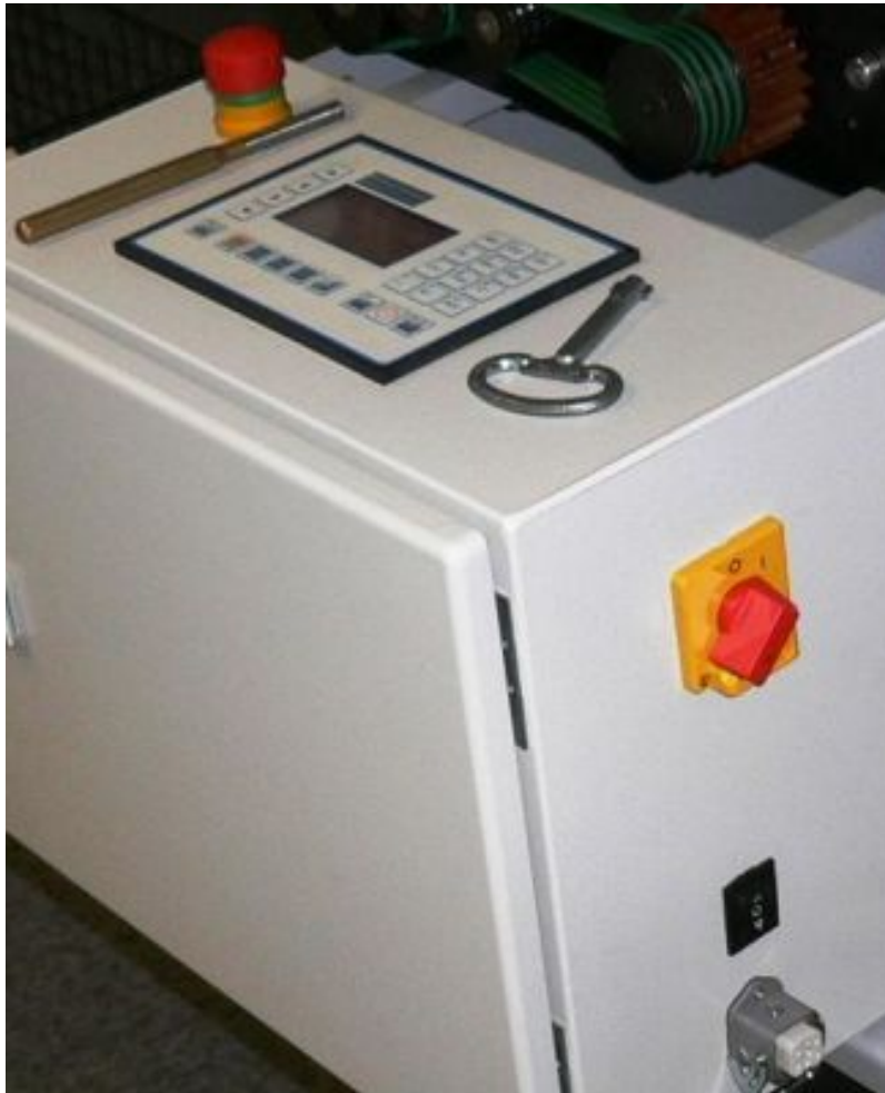
Schaltschrank mit Bedienteil - Display
