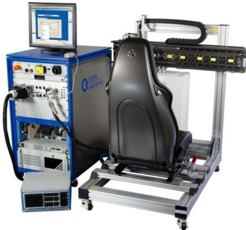
Kombination Testsystem für Autositze mit optischer Inspektion
