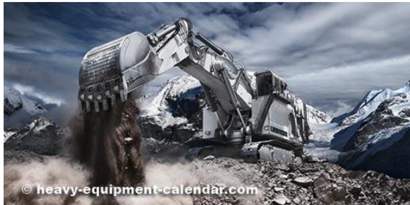
Liebherr R 9800 Miningbagger 800 Tonnen Einsatzgewicht und ein Löffelvolumen von 47,5 m 3
