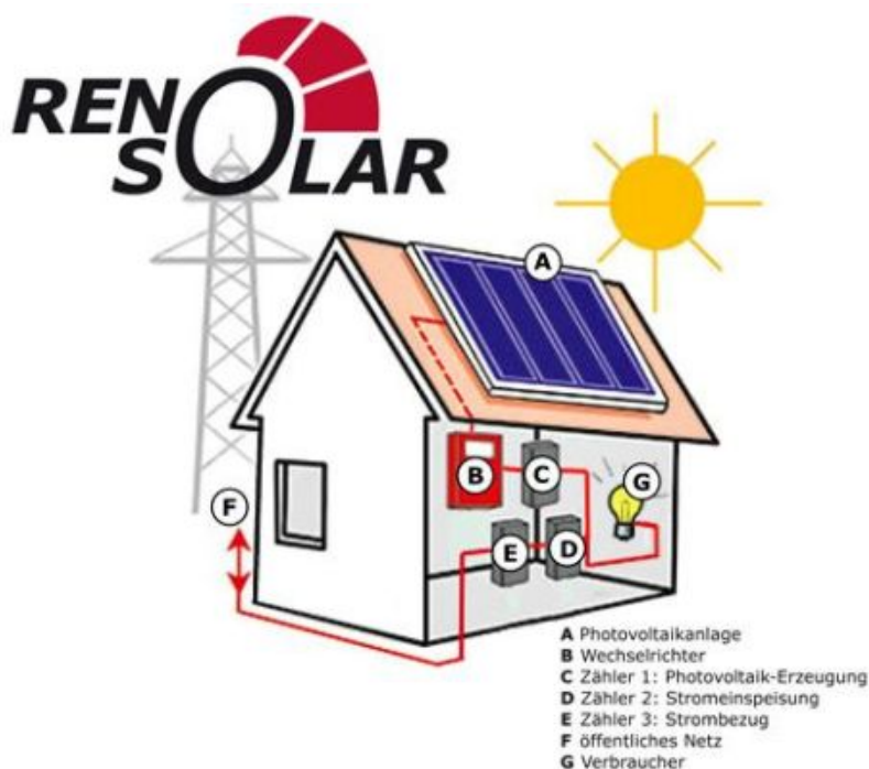
RenoSolar GmbH - Funktionsweise von Solarstrom-Eigenverbrauch
