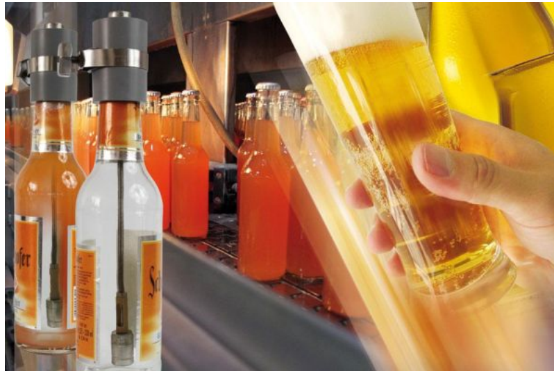
Zeitsparender Einsatz von Mini-Temperaturloggern in der Flasche
