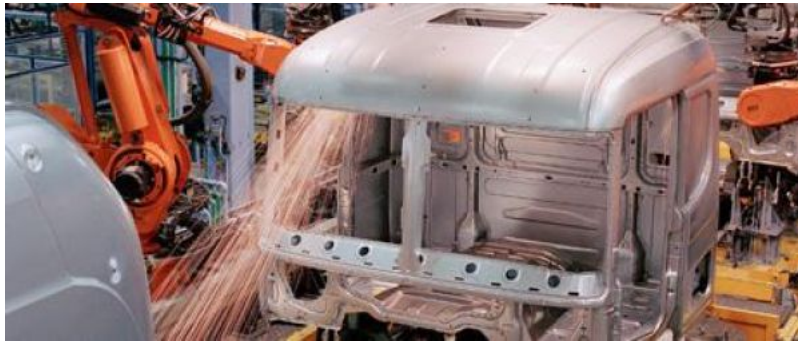
Effizienter Robotereinsatz in der Nutzfahrzeugfertigung
