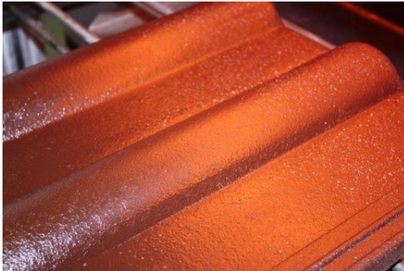
Infrarot-Strahler trocknen Schutzlack auf Dachziegeln
