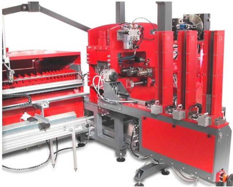
Automatisch beladene axiale Umformanlage inklusive Plattenmagazin und Handling
