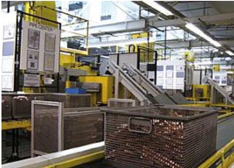
Die Pipecenter übernehmen den kompletten Rohrbearbeitungsprozess
