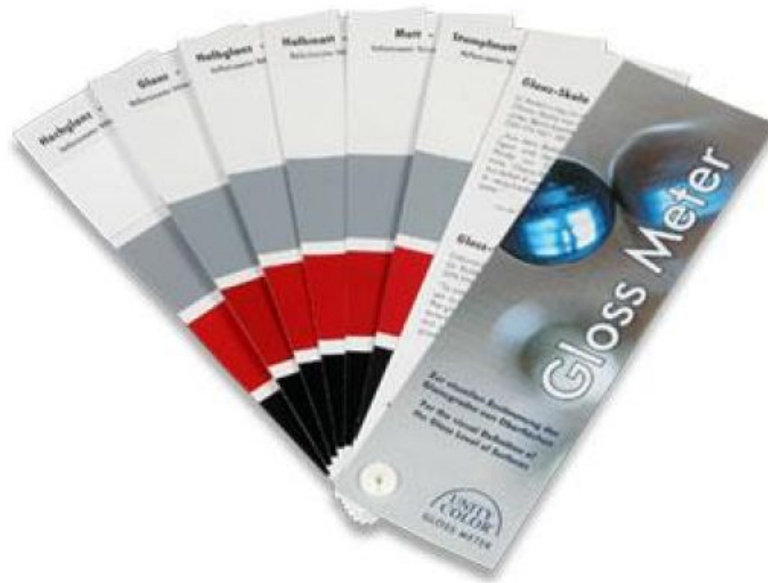
UNITY COLOR Gloss Meter für die visuelle Bestimmung des Glanzgrades einer Oberfläche. Bild: Torso-Verlag.
