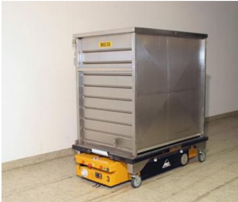
17 moderne freifahrende Unterfahrschlepper CAESAR arbeiten im Leopoldina-Krankenhaus in Schweinfurt
