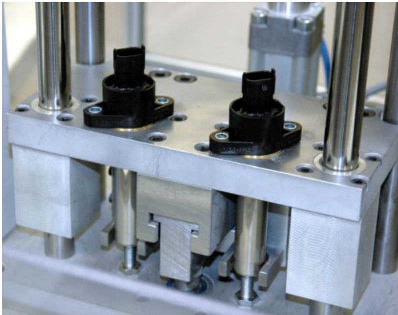
Montage der PTC-Heizelemente
