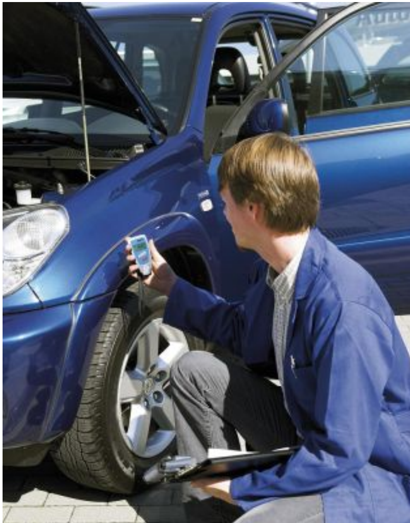
Prüfer beim Messen der Schichtdicke am Gebrauchtwagen
