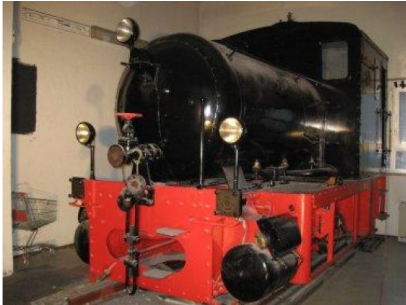
Dampfspeicherlok aus dem Jahre 1912
