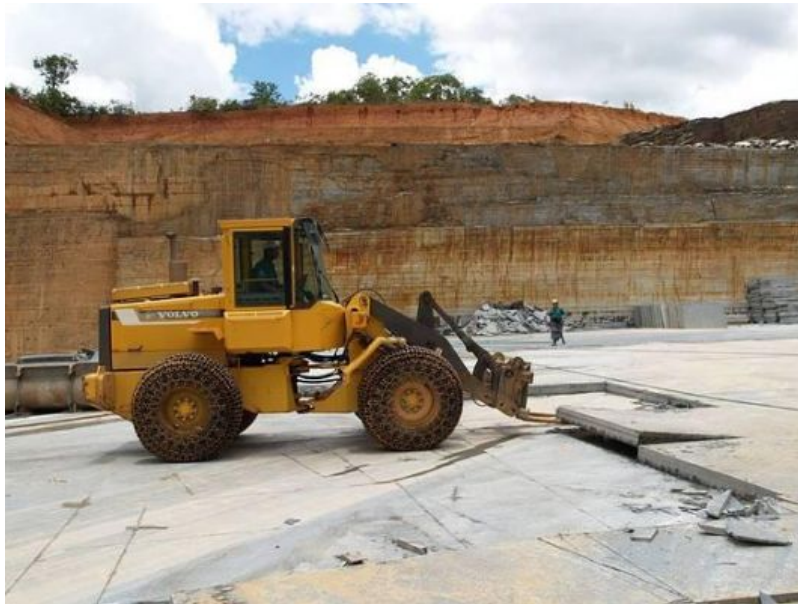
Radlader bricht im Steinbruch Schiefer-Rohblöcke
