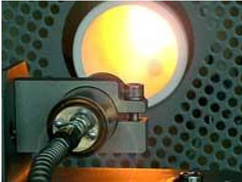
Das Quotienten-Pyrometer kann dank Lichtleitertechnik bei hohen Umgebungstemperaturen eingesetzt werden
